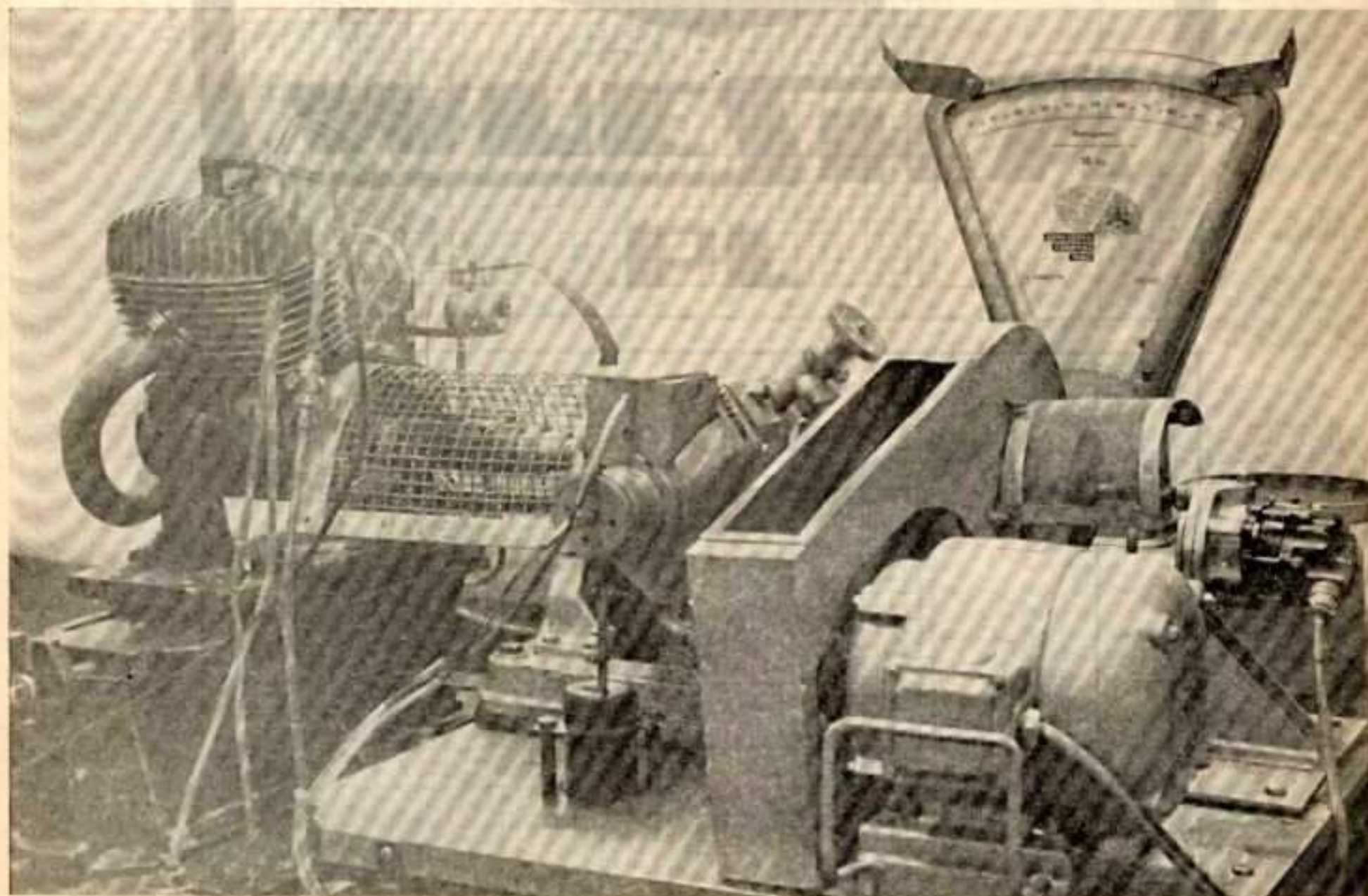
Rys. 3.4. Stanowisko dynamometryczne do zdejmowania charakterystyki zewnętrznej silnika
