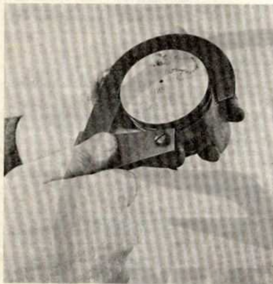
Rys. 4.3. Czyszczenie kanałków pierścieni tłokowych za pomocą przyrządu N.28.00 lub N.72.00
