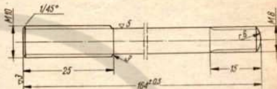
Rys. 7.50. Śruba dwustronna naprawcza do mocowania cylindra i głowicy
