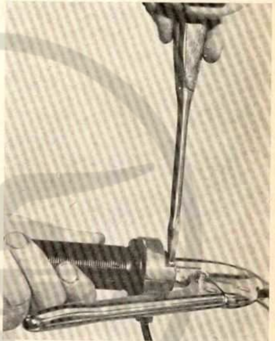
Rys. 5.35. Wykręcanie wkrętów mocujących obsadę ręczki pokrętnej gazu
