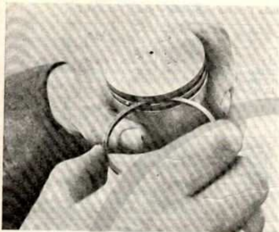
Rys. 4.6. Pasowanie pierścienia w rowku tłoka
