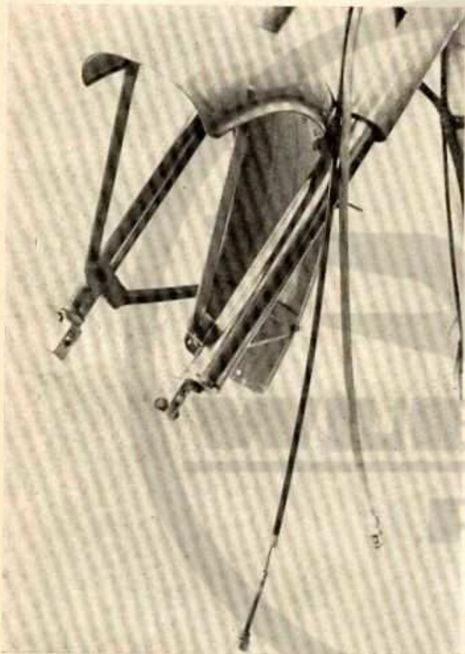
Rys. 5.41. Odlączona linka hamulca i wałek giętki szybkościomierza przed wymontowaniem błotnika
