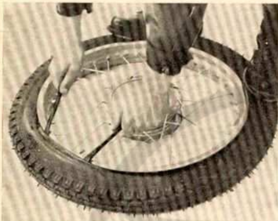
Rys. 4.25. Zdejmowanie ogumienia z koła
