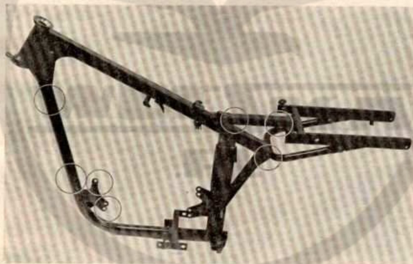
Rys. 8.1. Rama — miejsca ewentualnych pęknięć
