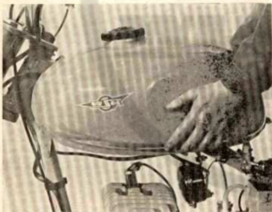
Rys. 5.5. Zdejmowanie zbiornika paliwa
