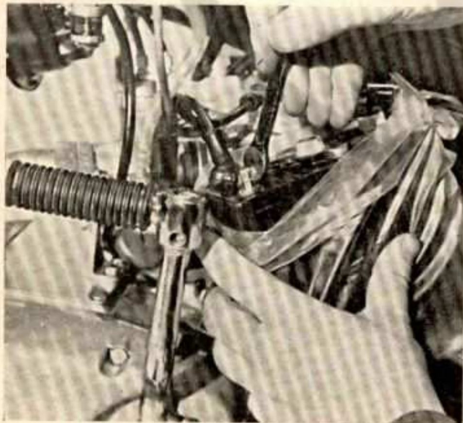
Rys. 5.58. Odlączenie przewodów instalacji elektrycznej od akumulatora
